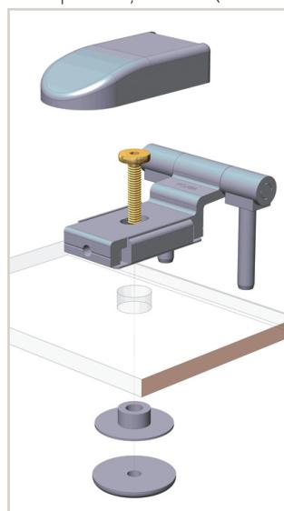
10. Ieskrūvējiet augšējo aplodas skrūvi slēdzenes pusē. Pārbaudiet stūru taisnumu, izmantojot stūreni/līmenrādi. Pārbaudiet spraugas, aizverot durvis.
