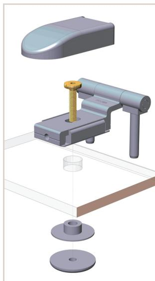
10. Fäst låssidans översta karmskruv. Kontrollera med vattenpass att karmen är i lod och med vinkelhake att karmen är vinkelrät. Kontrollera att springan mellan dörr och karm är jämn genom att stänga dörren.
